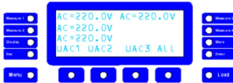
Drücken Sie die Funktionstaste unterhalb dem Wort **>All<**. Der Eingabewert wird in der Statuszeile eingeblendet. Nun können Sie mit den Drehgebern die gewünschte Spannung für alle Phasen einstellen.
