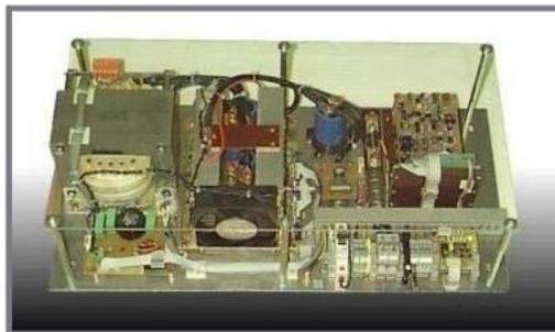
**Wechselrichter 2,0kVA 26V DC 1-phasig 115V 60Hz
